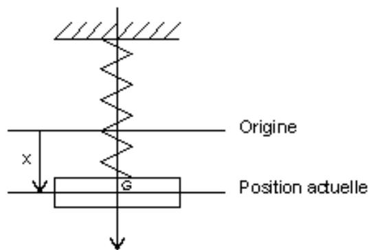
FIGURE 1 – Système masse ressort
