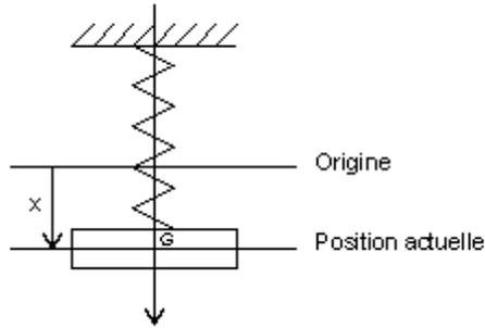
FIGURE 1 – Système masse ressort
